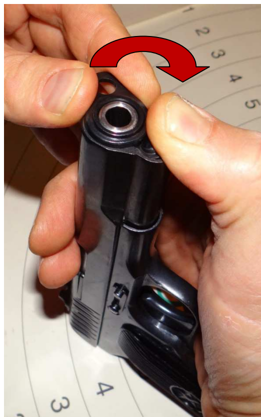
Zdjęcie 3 Przekręć łożysko o 180 stopni, aż guzik blokujący wskoczy w nie od spodu z charakterystycznym kliknięciem
