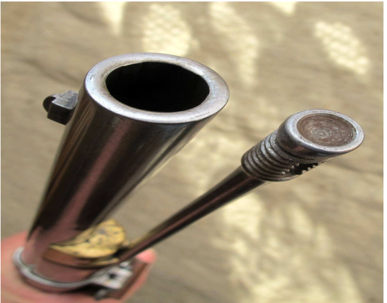
Lufa z widocznym gwintem, który u wylotu jest bardzo płytki
