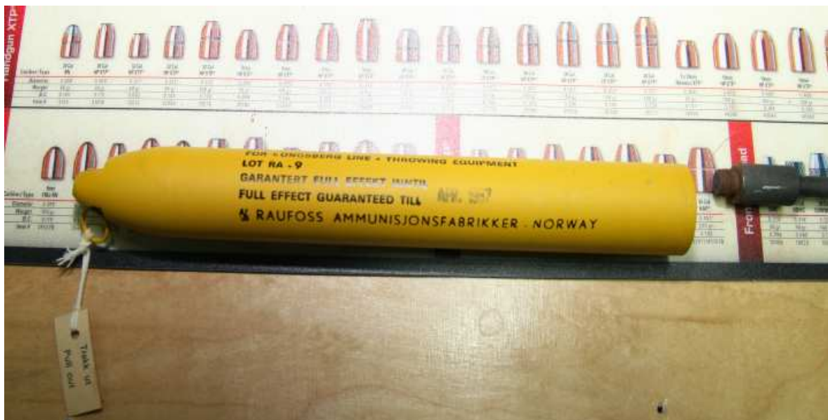
Rakietka i końcówka harpuna. Widoczna zawlecзка do aktywacji napędu rakietki
